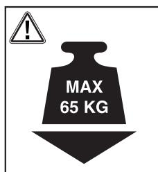
Die Schaufel darf höchstens mit 65 kg belastet werden.
