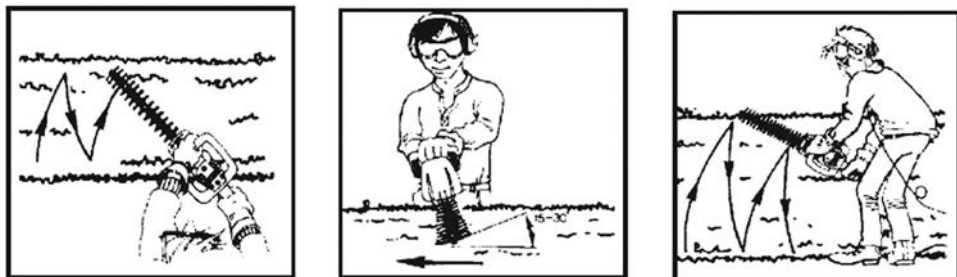
Рис. 4 Движения ножницами при обрезке
