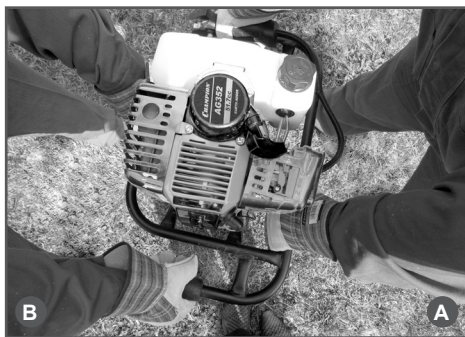
Рис.10 Положение рук при работе вдвоем
