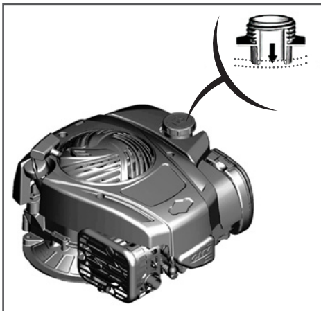
Рис. 14 Максимальный уровень топлива в топливном баке
