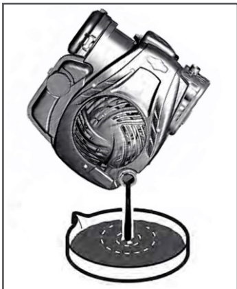
Рис. 18 Замена масла в двигателе
