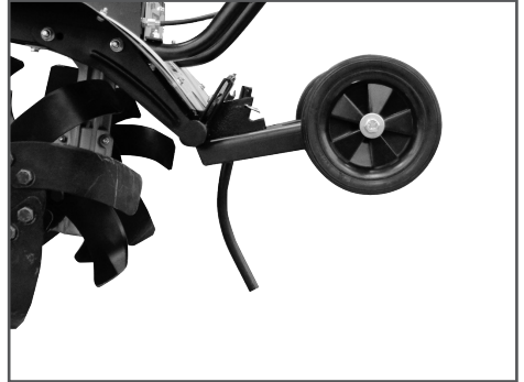
Рис. 17 Установка транспортировочной тележки и сошника в рабочее положение
