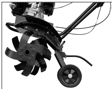
Рис. 26 Использование транспортировочной тележки
