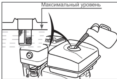
Рис. 16 Максимальный уровень топлива МОТОРНОЕ МАСЛО
