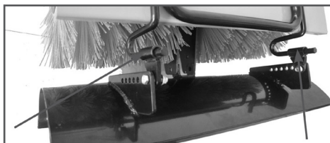
Рис. 5 Установка отвала на кронштейны щетки
