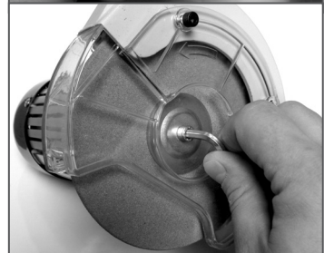
Рис. 5 Установка заточного диска
