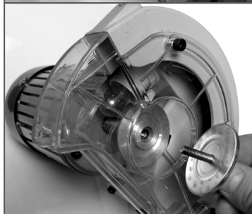
Рис. 4 Снятие прижимной шайбы заточного диска
