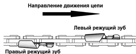
Рис. 12 Определение типа режущего зуба
