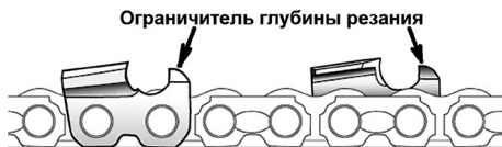
Рис. 13 Расположение пильной цепи на направляющей шине станка
