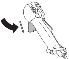
Нажмите на фиксатор рычага дросселя и удостоверьтесь, что он возвращается в первоначальное положение при его освобождении.
