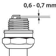
**ВНИМАНИЕ!** Всегда используйте только рекомендованный тип свечи! Использование ненадлежащего типа свечи может привести к повреждениям поршня/цилиндра. Следите за тем, чтобы свеча была оснащена т.н. изоляцией радиопомех.
