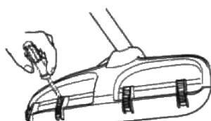
**Установка щитка для лезвия, лезвия для травы и ножа для травы**
