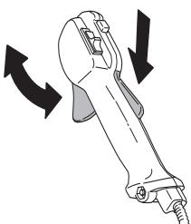
См. указания в разделе Запуск. Включите машину и полностью откроите дроссель. Отпустите рычаг дросселя и удостоверьтесь, что режущее оборудование останавливается и остается неподвижным. Если после постановки дросселя в положение холостого хода режущие оборудование продолжает вращаться, следует проверить регулировку холостого хода
