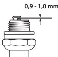
(553RS) Если двигатель теряет мощность, плохо запускается, плохо: Превде жсего держит обороты холостого хода: прежде всего проверьте свечу зажигания. Если свеча грязная, прочистите ее и проверьте зазор электродов, 0,6-0,7 мм. Свечу нужно менять через месяц работы или при необходимости чаще.
