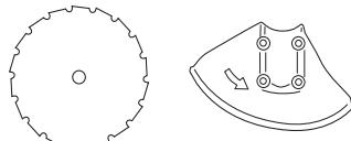
Лезвие и нож для травы предназначены для выкашивания сильной травы.
