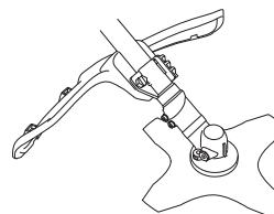
Проверьте, чтобы защита не была повреждена и чтобы на ней не было трещин. Замените защиту, если она была подвергнута удару или если на ней есть трещины.
