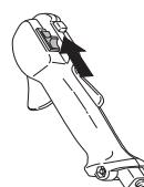
**ВНИМАНИЕ!** Двигатель останавливается путем выключения зажигания.
