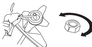
Нейлоновая прокладка контргайки не должна быть изношена настолько, чтобы ее можно было поворачивать вручную. Прокладка должна выдерживать усилие минимально 1,5 Нм. Гайку следует заменить после ее использования приблизительно 10 раз.
