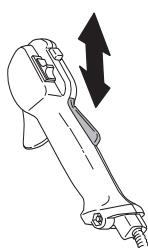
Проверьте, чтобы рычаг дросселя и фиксатор рычага дросселя перемещались свободно, а возвратные пружины исправно работали.
