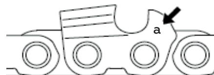
Шаг цепи (a) обозначен на конце глубиномера каждого фрезы
