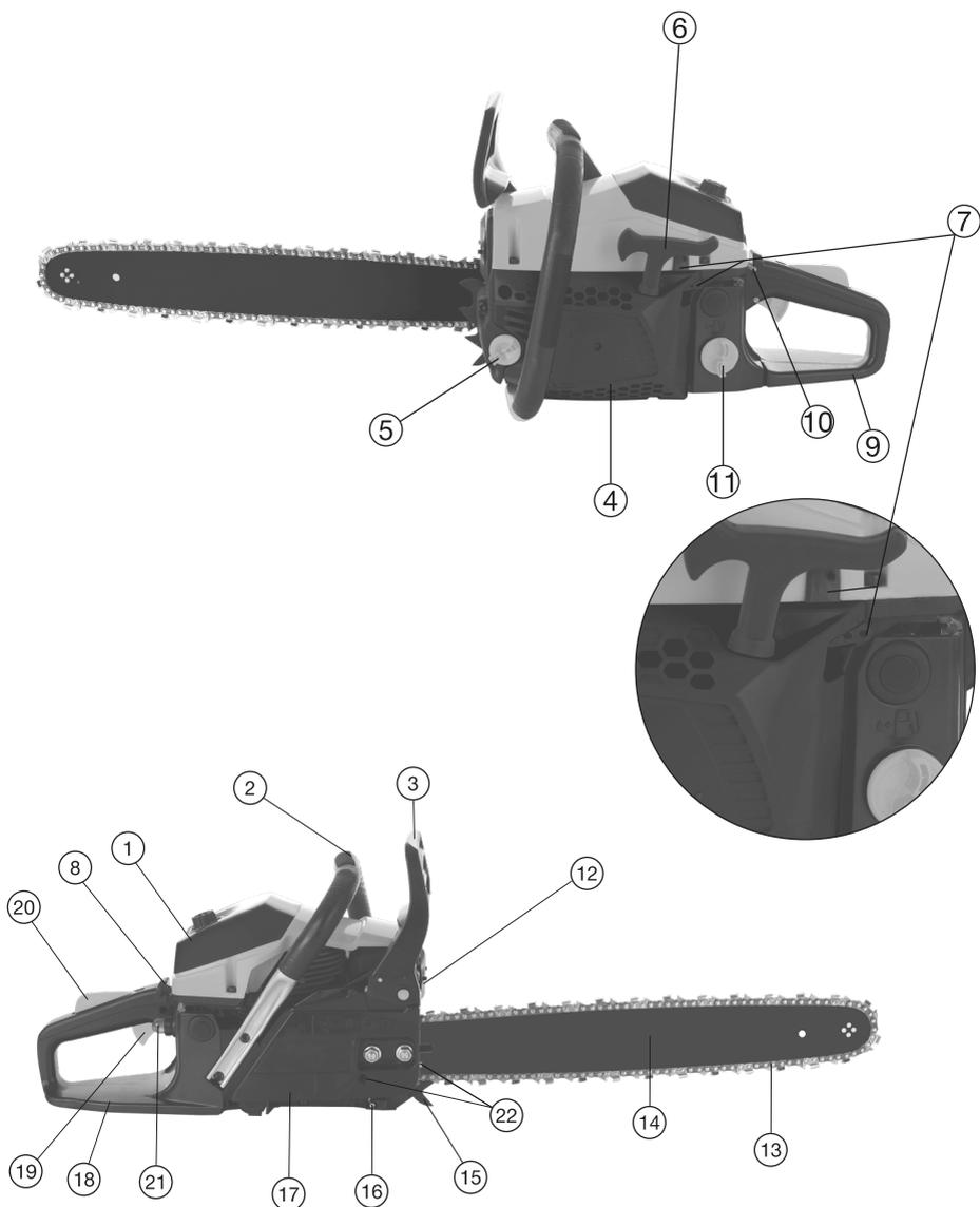
Конструкция пилы может отличаться от представленной в инструкции.
