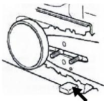
Проверьте, чтобы на уловителе цепи не было повреждений и чтобы он был надежно закреплен на корпусе бензопилы.
