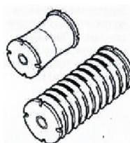
Система виброгашения снижает уровень вибрации, передаваемый от двигателя или цепи от ручки бензопилы. Корпус пилы, включая пильный механизм, отделен от ручек виброгасящими элементами.
