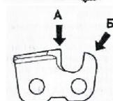
Режущий элемент цепи называется РЕЖУЩЕЕ ЗВЕНО и состоит из РЕЖУЩЕГО ЗУБА (А) и ОГРАНИЧИТЕЛЬНОГО ВЫСТУПА (Б). Величина срезаемой зубом стружки определяется разницей в высоте между этими двумя элементами. При заточке режущего зуба следует помнить о пяти важных факторах.
