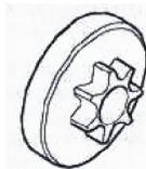
**А)** Зубчатое колесо (цельная звездочка привода). возможных звездочек привода:
