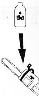
• Все выпускаемые нами модели бензопил имеют автоматическую систему смазки. Во всех моделях также предусмотрена регулировка потока масла.
