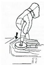
Между валом двигателя и барабаном (чашкой) сцепления находится игольчатый подшипник, который требует смазки. Для этого следует применять специально предназначенную масленку и высококачественную смазку для подшипников. Следует обратиться в авторизованный сервисный центр.
