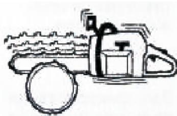
Пиление тяжелых пород деревьев (большинство широко-лиственных деревьев) вызывают более сильную вибрацию, чем пиление мягких пород. Работа затупившейся или неисправной цепью приводит к повышению уровня вибрации.
