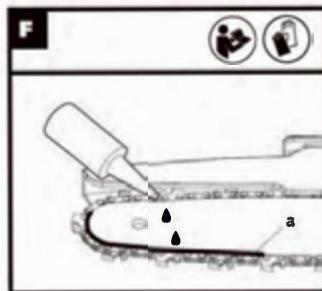
Масло равномерно распределится по цепи. Пильная цепь и шина смазаны.
