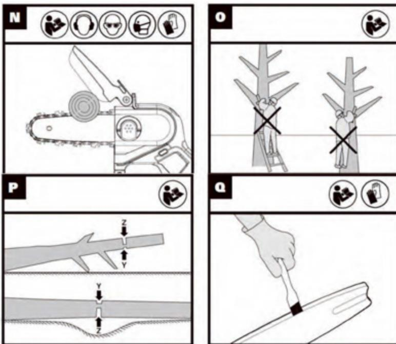
**ПРЕДУПРЕЖДЕНИЕ:** При обрезке веток под каким то весом, нагрузкой (т.е. находящихся в напряжённом состоянии), соблюдайте крайнюю осторожность. Будьте внимательны к тому, что древесина может отскочить назад и травмировать оператора, что может привести к серьезным травмам.
