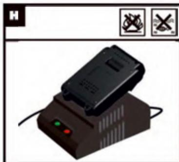
Литий-ионный аккумулятор защищен от глубокого разряда. Когда у аккумулятора глубокий разряд, то специальная защита отключит аккумулятор.
