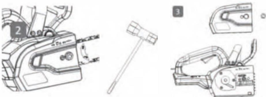
Рис. 3: Поверните винт натяжки цепи по часовой стрелке, чтобы переместить натягивающую планку как можно ближе к ведущей звездочке.
