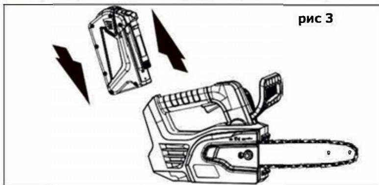
**ПРИМЕЧАНИЕ!** Перед первым использованием полностью зарядите аккумуляторы. Смотрите руководство по эксплуатации зарядного устройства.
