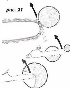
На рис. 21 показана траектория возможного отскока. Для исключения возможности отскока работайте только нижней частью шины пилы, никогда не работайте верхней частью шины, в этом случае пила стремится в сторону оператора как на рис.20
