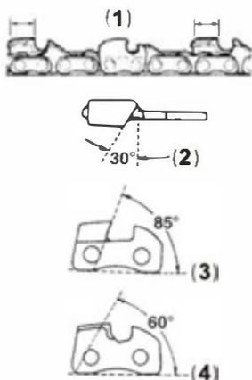
Необходимо немного скруглить переднюю часть зуба для исключения отскока при работе как показано на рис. 36.
