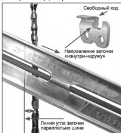
Рис. 18 Определение угла заточки
