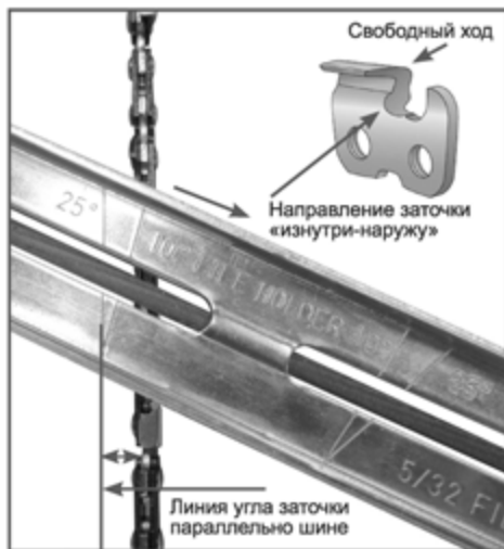
Рис. 16 Определение угла заточки
