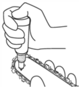
Рис. 20 Смазывание подшипника ведомой звездочки шины
