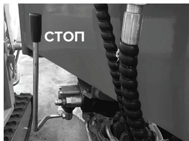
**С** При нажатии рукоятки управляющего клапана во внутреннее положение гидравлические двигатели будут вращаться в обратном направлении, после чего материал будет возвращен обратно.
