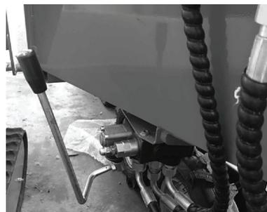
**В** При переводе рукоятки регулирующего клапана в среднее положение гидромоторы не будут вращаться, а материал подаваться.
