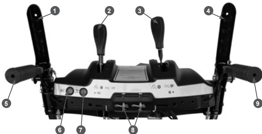
Рис. 2 Панель управления (вид со стороны оператора)
