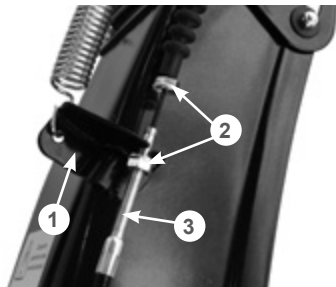
Рис. 21 Установка оболочки троса управления дефлектором жёлоба
