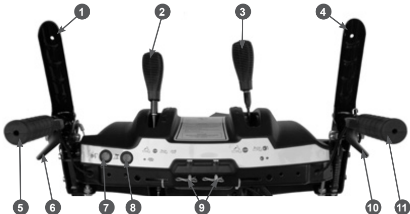
Рис. 3 Панель управления (вид со стороны оператора)
