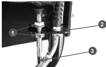
Рис. 11 Крепление оболочки троса включения хода
