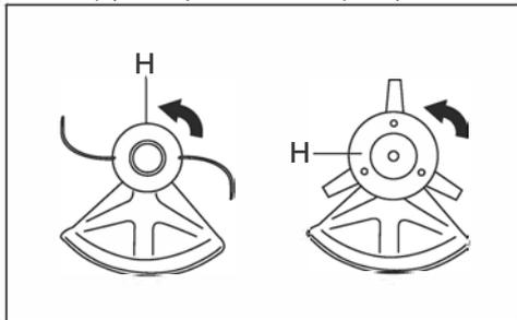
8. Установите головку триммера/пластмассовые ножи (H). Поверните головку триммера/пластмассовые ножи против часовой стрелки.
