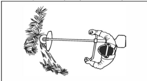
4. При подрезке травы наклоняйте нож влево.
