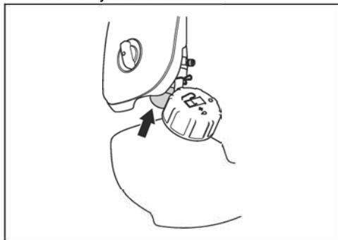
3. Установите заслонку в рабочее положение, затем потяните ручку шнура стартера, пока двигатель не запустится.
