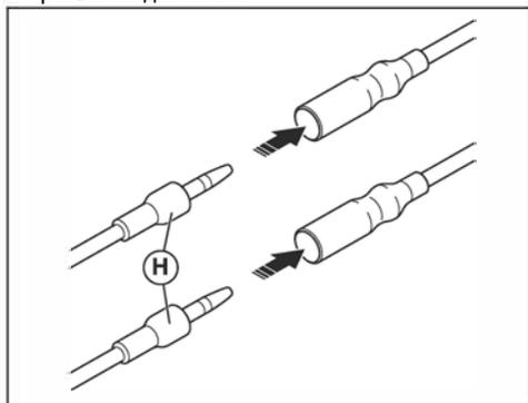
11. Установите провода и разъемы выключателя с помощью зажима (I).
