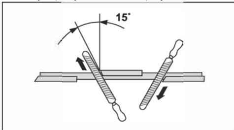
**Примечание:** Если диск сильно изношен, затачивайте кромки зубьев плоским напильником. Продолжите заточку круглым напильником.
