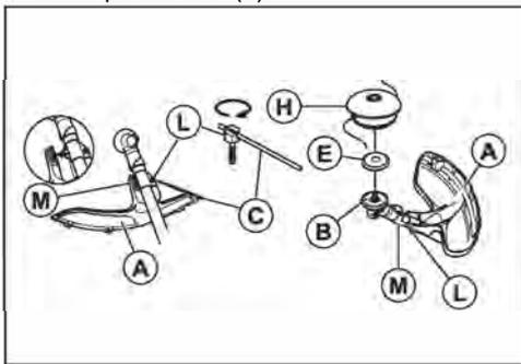
4. Вставьте стопорный штифт или шестигранный ключ (C) в паз на головке винта и затяните.
