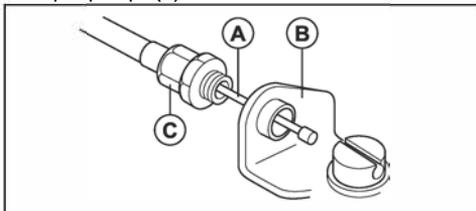
3. Установите соединительную муфту (С) полностью в кронштейн карбюратора.
