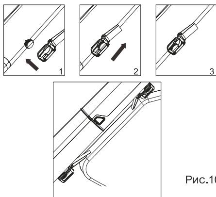
1. Чтобы снять мешок, высвободите мешок из держателей ремня с обеих сторон трубы и просто нажмите кнопку разблокировки трубы, чтобы снять мешок (Рис.11).
