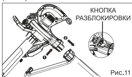
2. Чтобы снять узел всасывающей трубы, освободите крышку с крюка трубы, поверните ручку блокировки, чтобы разблокировать ее, а затем извлеките трубу из корпуса воздуходувки (рис. 12).
