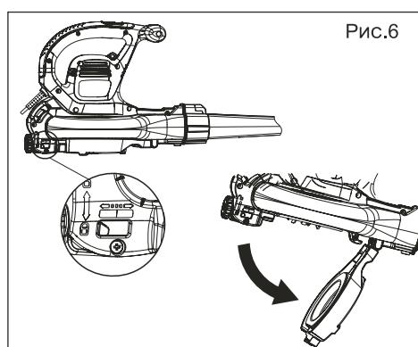
3. Сняв выдувную трубку, вставьте конец всасывающей трубы в задний зажим воздуходува до зацепления. Поверните ручку блокировки, чтобы зажать трубу (фиксатор находится в крайнем правом положении, рис. 7).
