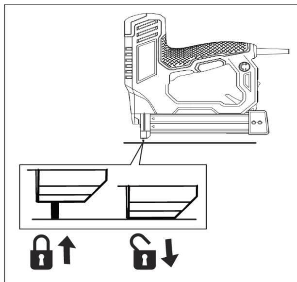
Рис. 4. Предохранитель
