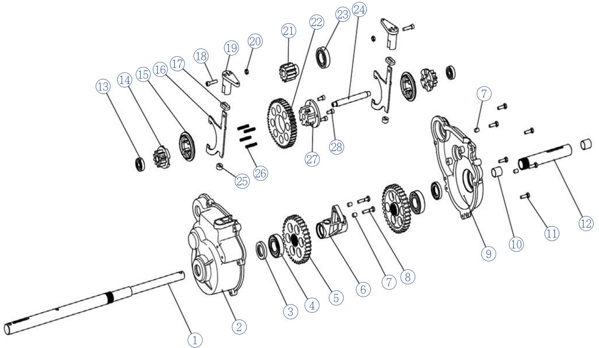
**Модель агрегата: WB 1576ET (Снегоборщик 11 кВт/15 л.с. 420 см<sup>3</sup>)****Список запасных частей**
